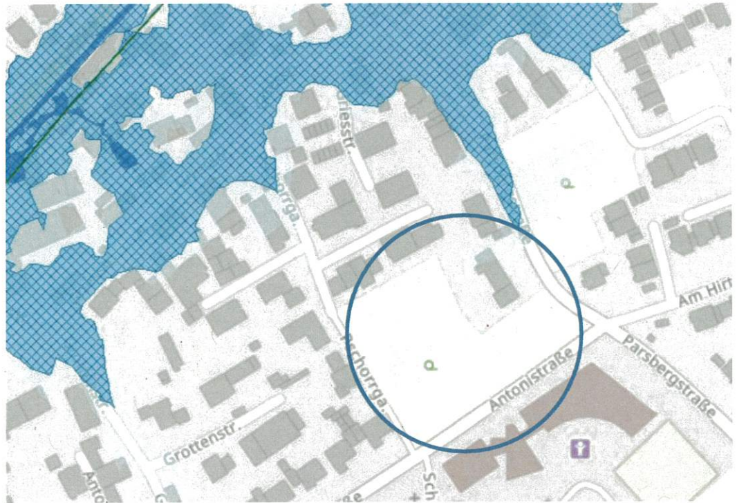
Abb. 5 Festgesetztes Überschwemmungsgebiet HQ 100 (dunkelblau kariert), Hochwassergefahrenfläche HQ extrem (hellblau), ohne Maßstab, Quelle: Bayerische Vermessungsverwaltung, Stand 19.08.2025
